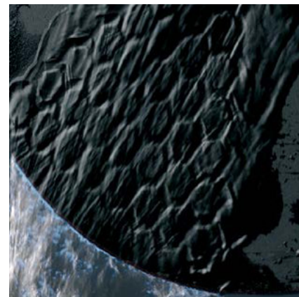
С 3D-поверхностью вся вода, распыляемая между шестиугольниками, поступает в место реза, поэтому охлаждение образца становится еще более эффективным.
